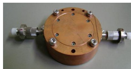
周波数依存性測定用マルチモード TE 011 空洞共振器
